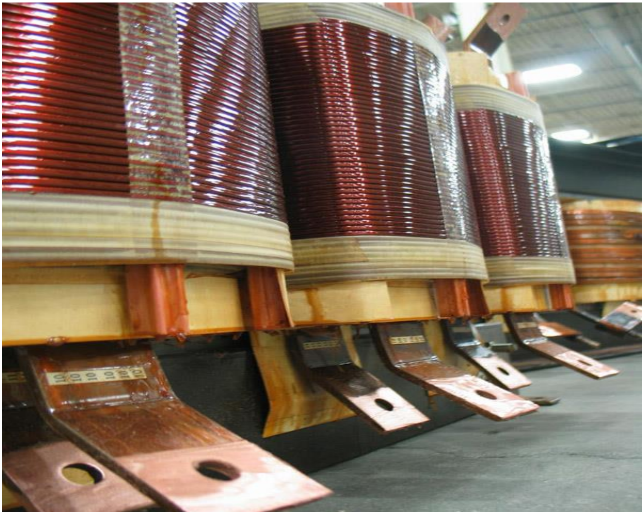
Hình H1.5: Các cuộn dây của biến áp 3 pha dùng dây tráng men tiết diện tròn và tiết diện chữ nhật.
