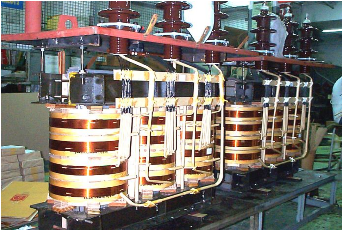
HÌNH H.12: Dây quấn và các đầu ra của dây quấn trên biến áp 3 pha.
